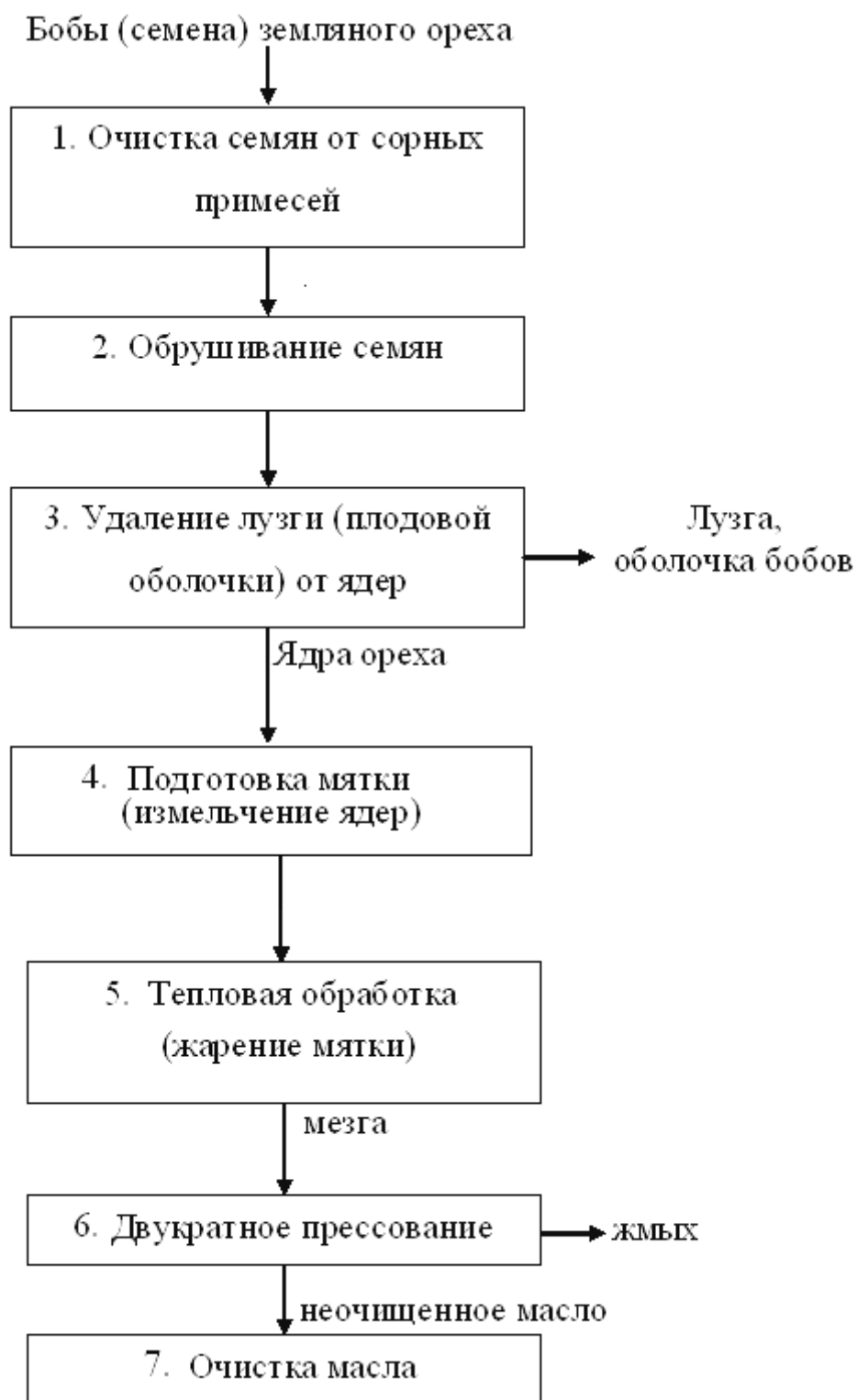
Рис.1.6. Технологическая схема получения арахисового масла
