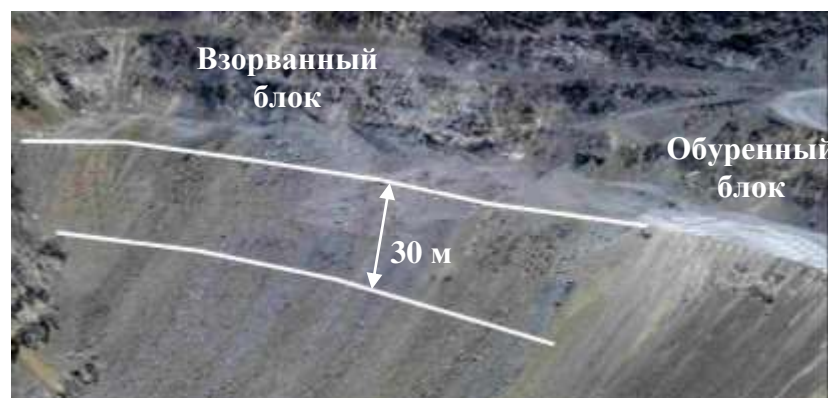
Рис. 4.11. Результаты натурального эксперимента по взрыву 30 метрового уступа
