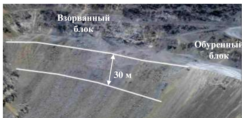
Рис. 3.3. Результаты натурального эксперимента по взрыву 30 метрового уступа
