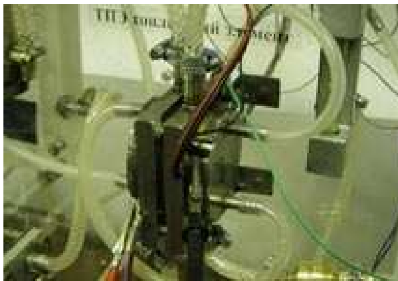
1- расм. Деталларининг ейилишини мойнинг фракцион таркиби ёрдамида текшириш қурилмаси
