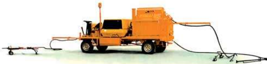
Рис. 2.9. Универсальная самоходная машина для герметизации трещин модели UVM 500 фирмы Breining (Германия)
