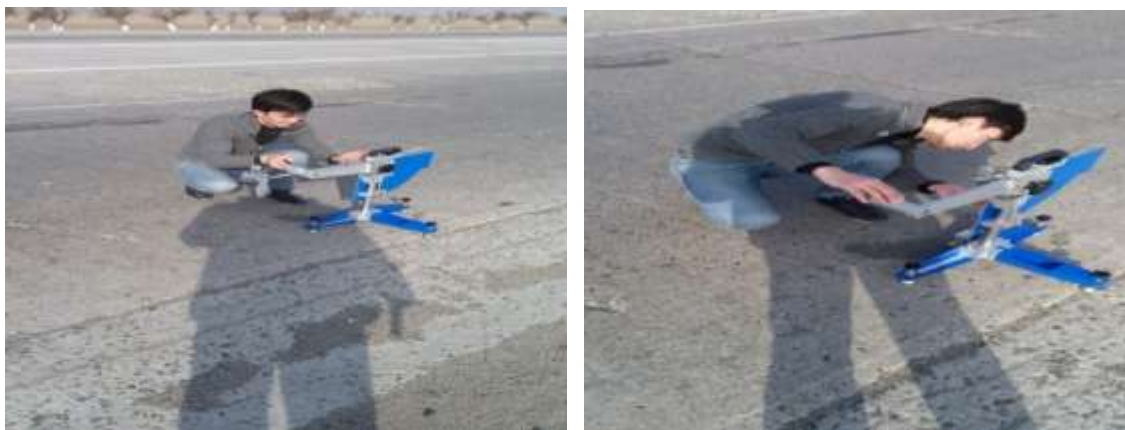
2.14-расм. Цементбетон қопламасининг тишлашиш коэффициентини замонавий Cooper Pendulum Skid Resistance қурилмаси ёрдамида ўлчаб баҳолаш.
