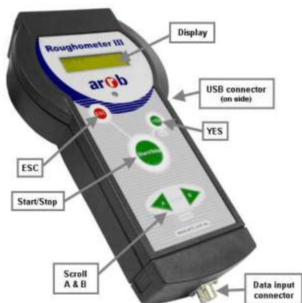
2.21-расм. “Rafometr III” қурилмасининг бошқариув а) функциялари, б) бошқарув схемаси.
