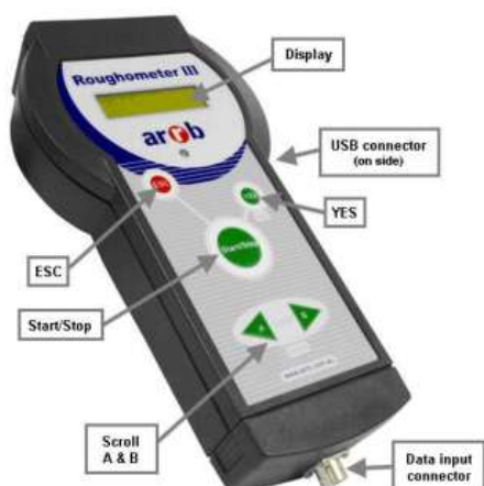
1.14-расм. “Rafometr III” қурилмасининг бошқарув а) функциялари, б) бошқарув схемаси.
