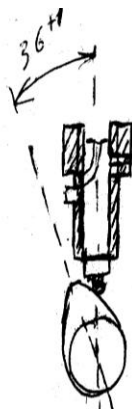
5-rasm. Yoqilg'i uzatila boshlaganda plunjer o'qiga nisbatan kulachok o'qining joylashish holati.
