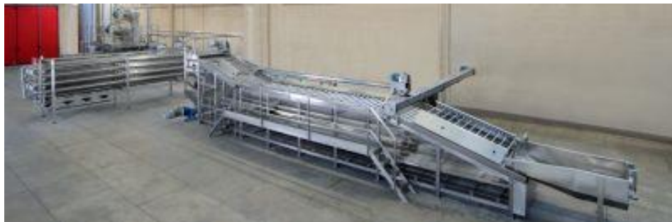
Мод.LONG-RUN 20 Группа промывки: сортировка, измельчитель, насос (увеличить)
