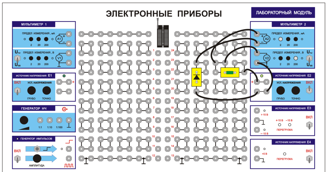
2.9 – расм. Ярим ўтказгичли диод ВАХини тескари шахобчасини тадқиқ этиш учун йиғилган УЛС лаборатория модулининг ташқи кўриниши.
