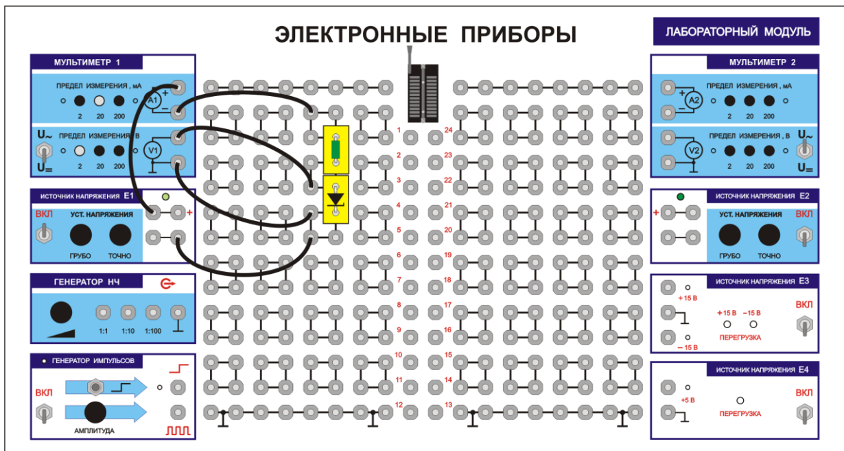
2.13 – расм. Стабилитрон ВАХини тўғри шахобчасини тадқиқ этиш учун йиғилган УЛС лаборатория модулининг ташқи кўриниши. Тадқиқотлар натижаларини 2.3- жадвалга киритамиз.
