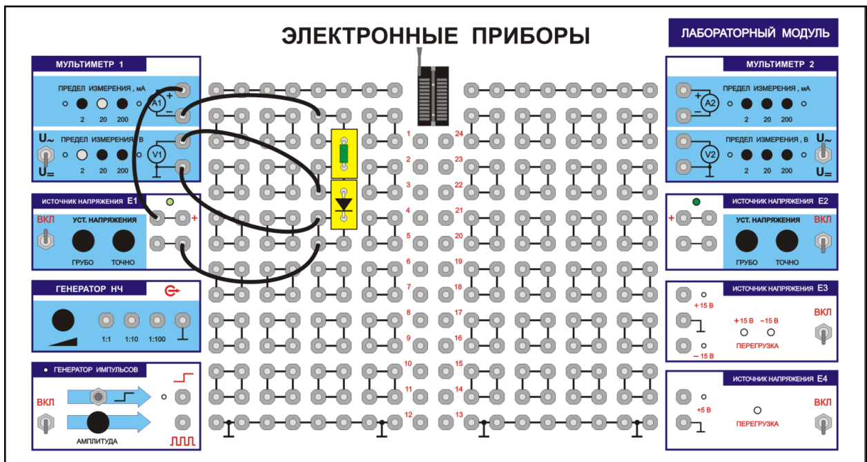
2.8 – расм. Ярим ўтказгичли диод ВАХини тўғри шахобчасини тадқиқ этиш учун йиғилган УЛС лаборатория модулининг ташқи кўриниши.
