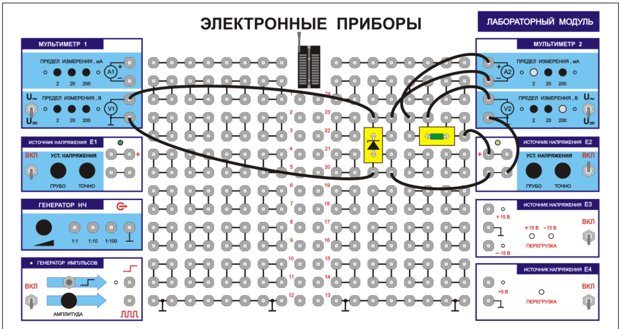
2.14 – расм. Стабилитрон ВАХини тескари шахобчасини тадқиқ этиш учун йиғилган УЛС лаборатория модулининг ташқи кўриниши.
