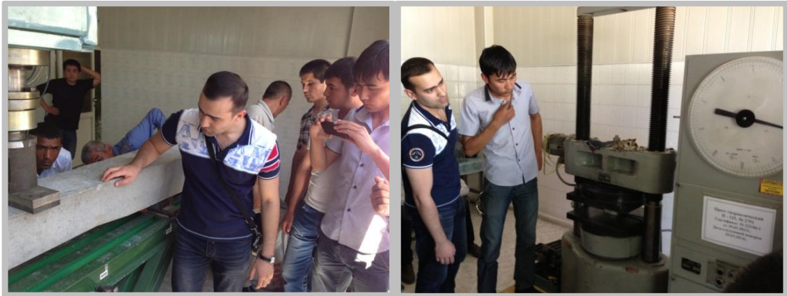
Рис. 20 Испытания шпал на прочность и устойчивость
