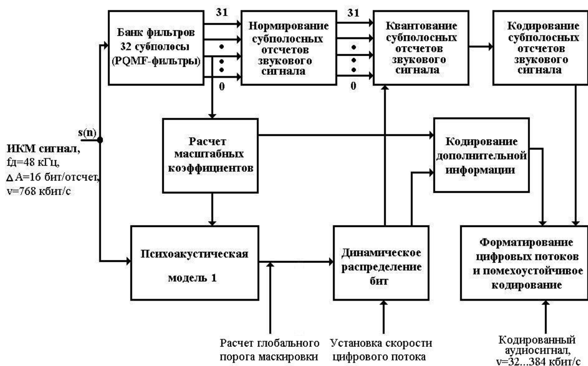
Рис. 1.2 Структурная схема кодера MPEG стандарта ISO/IEC 11172-3, Layer-1 и Layer-2
