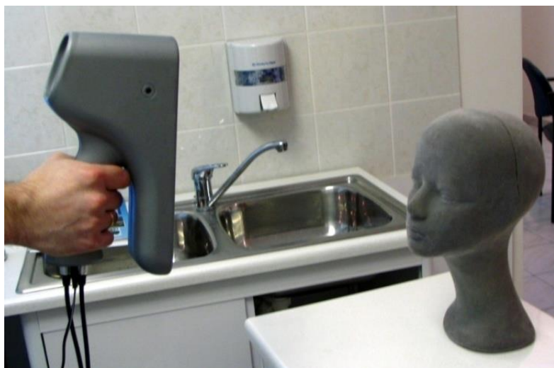
Рис.97 Лицевой трехмерный сканер
