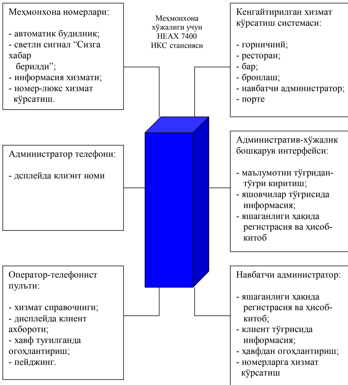
Расм-21.Миллиэниум HEAX 7400 ИКС мисолида меҳмонхона учун станция схемаси.
