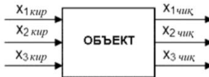
2.1-расм. Бир неча ўзаро боғланган кириш – чиқиш сигналларидан тузилган объект схемаси
