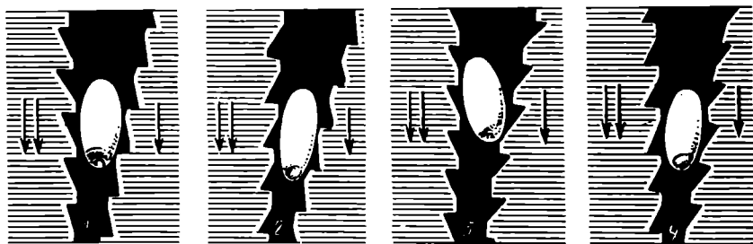
Рис. 70. Четыре варианта взаиморасположения рифлей валцов:
