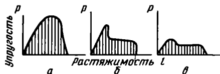
Рис. 5. Зависимость упругости от растяжимости клейковины:
