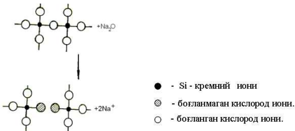
3-rasm. Silikatli shisha xosil bo‘lish strukturasi.
