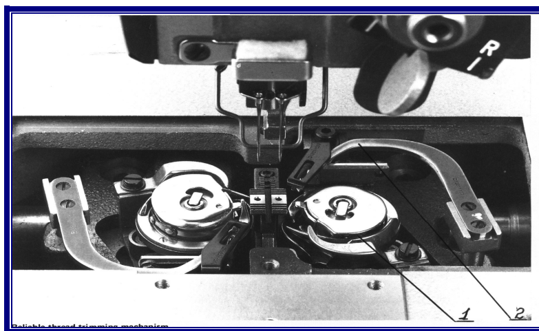
28-расм, б. LH -1162 -S-5-4B русумли тикув машинасида моки ва четлатгичлар жойлашиши
