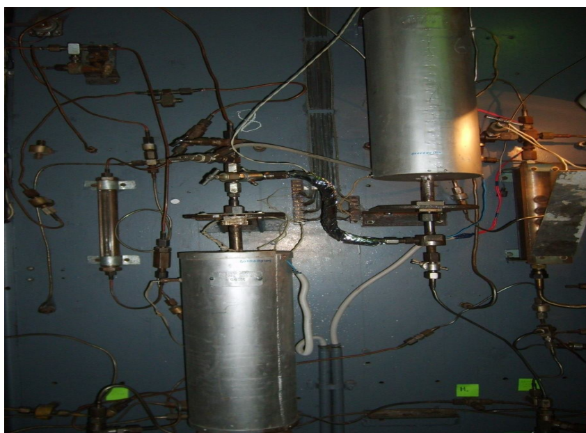
23-расм. Метанолдан ДМЭ синтези ва уни бензинга айлантириш тажриба блоки.
