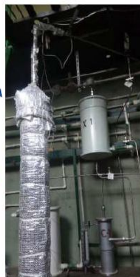
3 литр Pd/сибунит катализатори мавжуд бўлган синтез газини олиш катализатори
