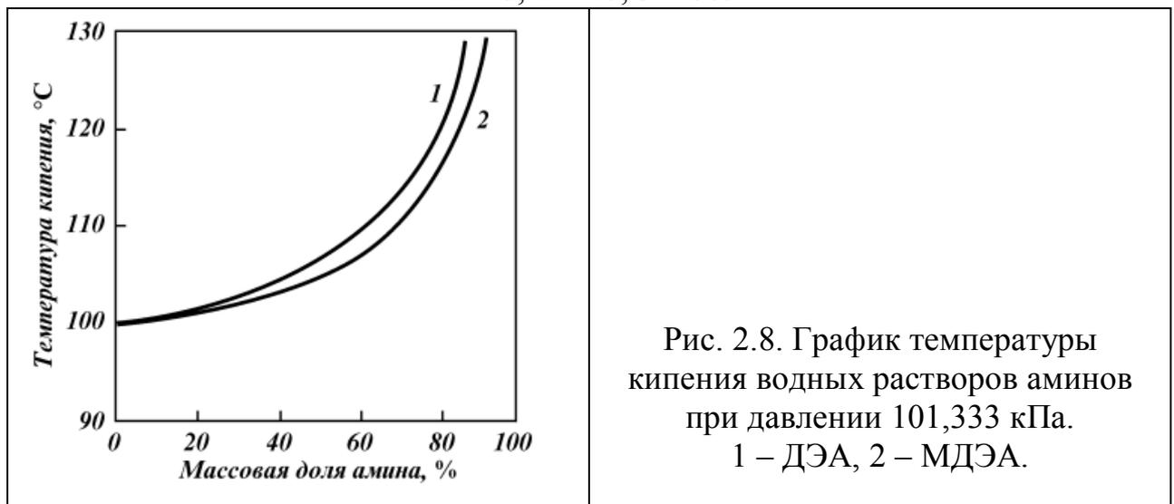
Рис. 2.8. График температуры кипения водных растворов аминов при давлении 101,333 кПа.
