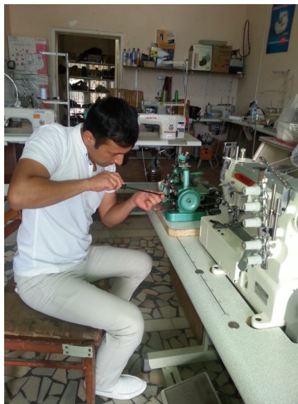
4.3-расм. Лазер нури остида пухталанган чалиштиргичларни ишлаб чиқаришда синаб кўриш.
