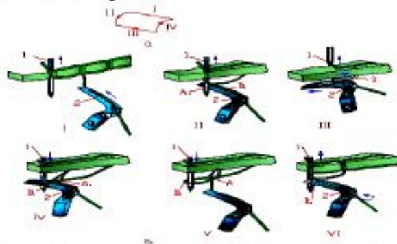
3-расм. Икки ипли занжирсимон баҳянинг ҳосил бўлиши а) чалиштиргич ҳаракат траекторияси. б) баҳянинг ҳосил бўлиши
