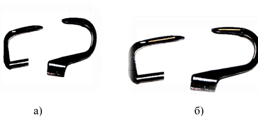
3.1-расм. Чалиштиргич ишчи юзаси ейилишга чидамли бўлиши учун лазер нурида пухталанган.
