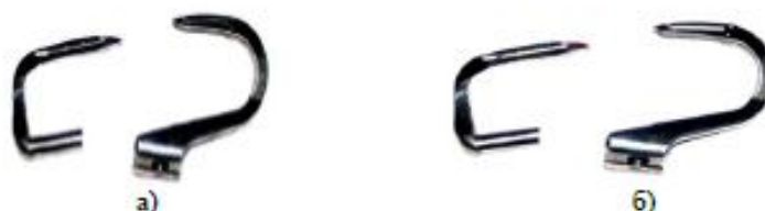
4-расм. Чалиштиргич ишчи юзасига ейилишга чидамли бўлган қаттиқ металл қопламасини қоплаш.
