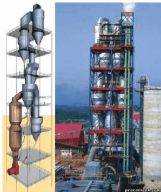
2 - расм. Декарбонизаторли иссиқлик алмашиниш ускуналарининг модели ва яққол кўриниши.
