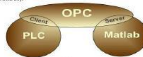
Схема связи Matlab и PLC при помощи OPC
