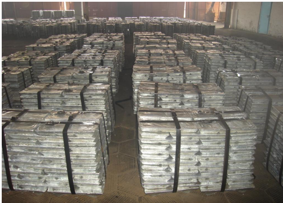
8-rasm. Olmaliq tog‘ metallurgiya kombinatidagi rux zavodida olingan va sotuvga tayyorlangan sof rux metali(99,99% li)
