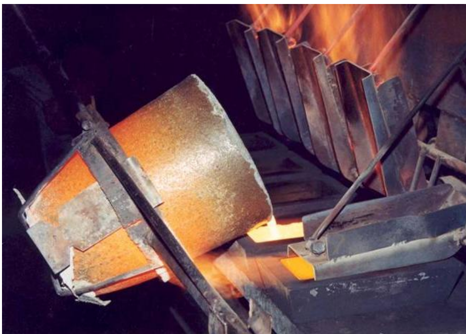
14 -rasm. Sof toza oltin (99,99% li) quymasi qoliplarga quyish jarayoni(Olmaliq mis eritish zavodi).
