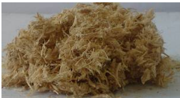
3.7-расм. Иккинчи босқичдан кейин олинган ярим тайёр целлюлоза намунасининг умумий кўриниши.
