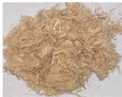
3.7-расм. Иккинчи босқичдан кейин олинган ярим тайёр целлюлоза намунасининг умумий кўриниши.
