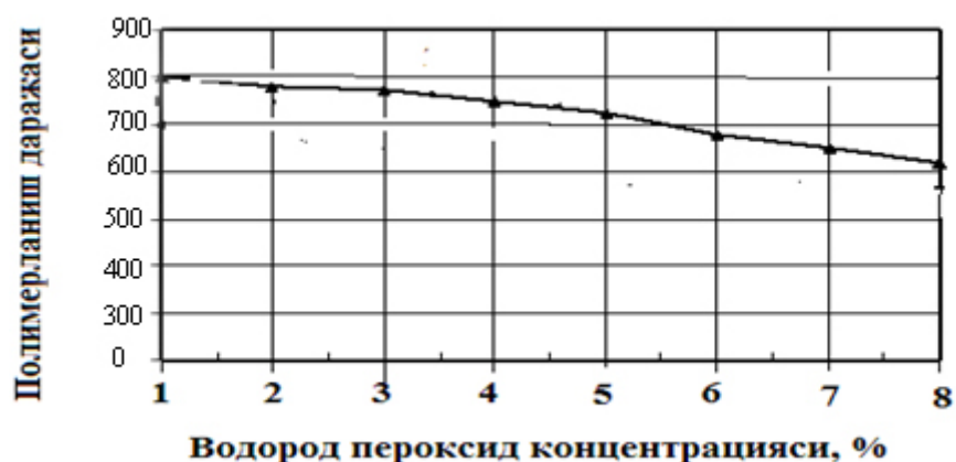
3.2-расм. Целлюлозанинг полимерланиш даражасига водород пероксид концентрациясининг таъсири.
