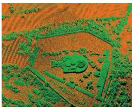
Рис. 7. Трехмерное облако точек лазерных отражений
