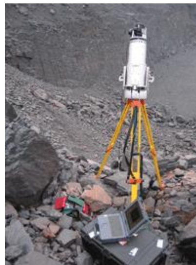
Рис. 9. Наземный лазерный сканер
