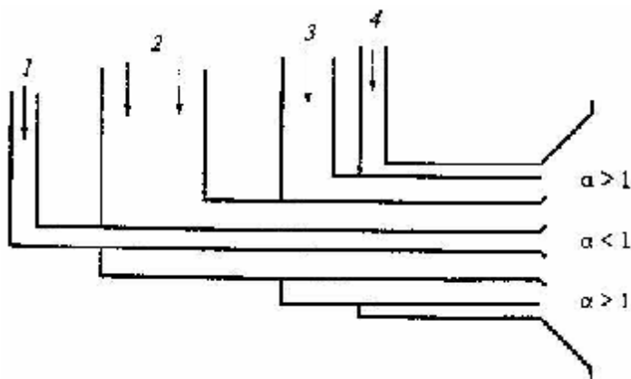
2.5-расм. \text{NO}_x миқдори кам чиқувчи чанг кўмирли горелкаларни принципиал схемалари.
