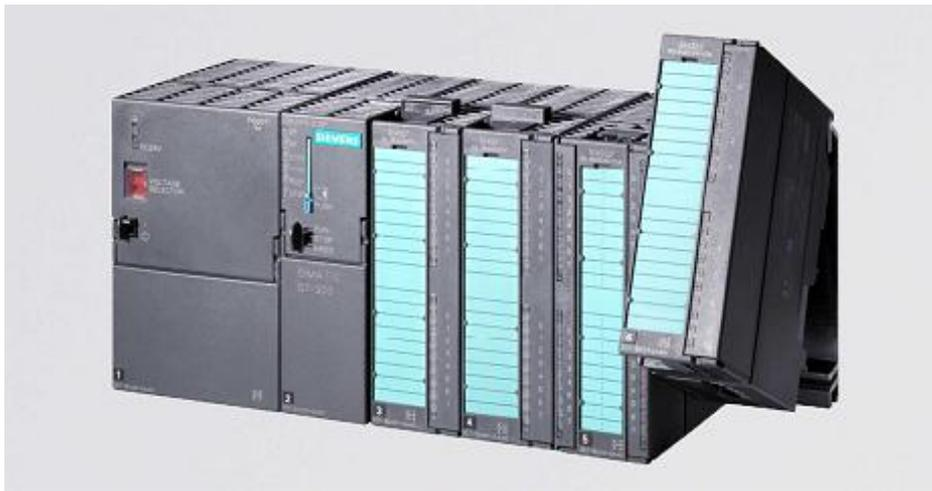
**Рис.2.4. Программируемый логический контроллер SIMATIC S7-300**
