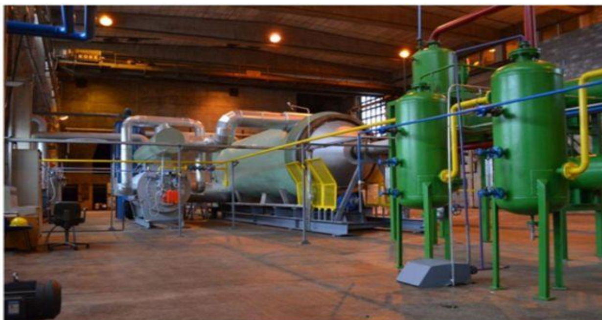
Расм-5. Пиролиз газларини ажратиш блоги
