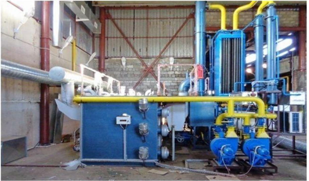
Расм -8. Пиролиз жараёни учун ярим саноат ишлаб чмқариш қурилмаси умумий кўриниши.
