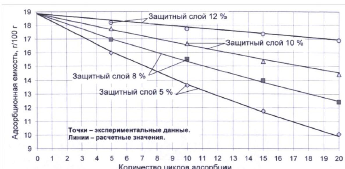
3.10-расм. NaCl таъсирида цеолит CaA сигимининг тушиши динамикаси
