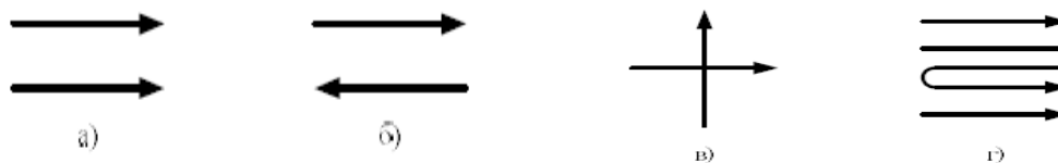
1.4-расм. Иссиқлик ташувчилар ҳаракат йўналишларининг схемаси. а – тўғри оқимли; б – қарама-қарши оқимли; в – кесишувчи оқимли; г – мураккаб оқимли.
