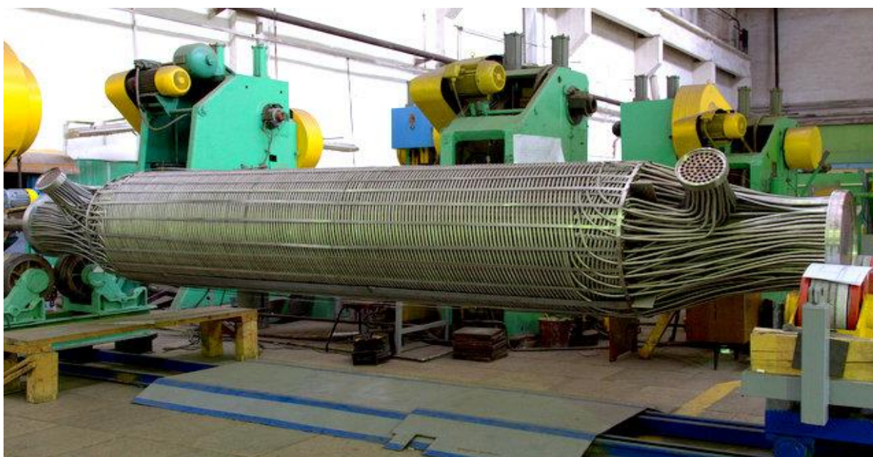
1.6-расм. Қувур ўрамли иссиқлик алмаштиргичнинг умумий кўриниши
