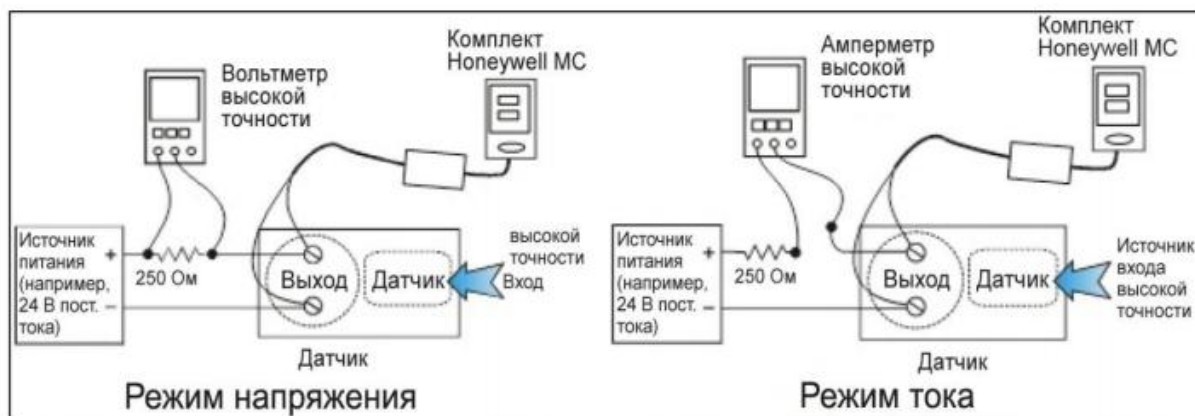
2.8-расм-Кириш сигналини калибровкакаш схемаси.
