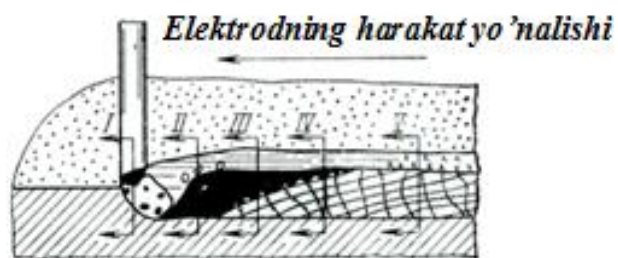
1-rasm. Flyus qatlami ostida suyultirib qoplash sxemasi (bo'ylama kesimi)
