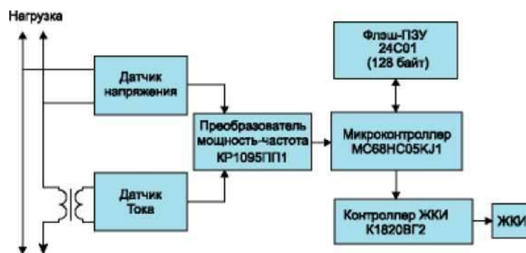
1.4-rasm. Oddiy elektrn hisoblagichning blok-sxemasi.
