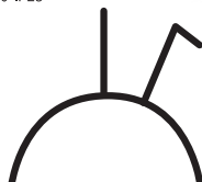
Блок: розетка + выключатель для скрытой установки, IP20-IP23
