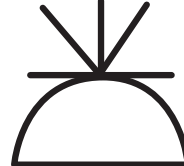
Блок: розетка + выключатель для открытой установки, IP20-IP23
