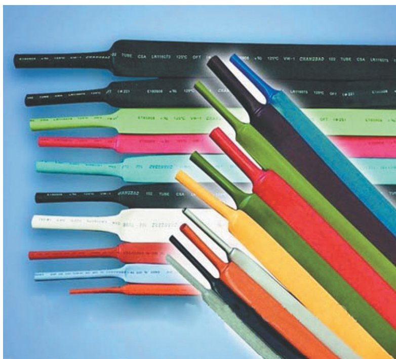
Термоусадочные трубки — это изделия из полиолефина, главным свойством которых является способность уменьшать свой диаметр (усаживаться) под воздействием высокой температуры (от 70 до 120 °C) в несколько раз. При усадке трубка плотно охватывает предмет и обеспечивает тем самым механическую или электрическую защиту.
