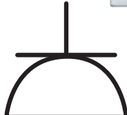
Розетка двухполюсная сдвоенная для скрытой установки, IP20-IP23
