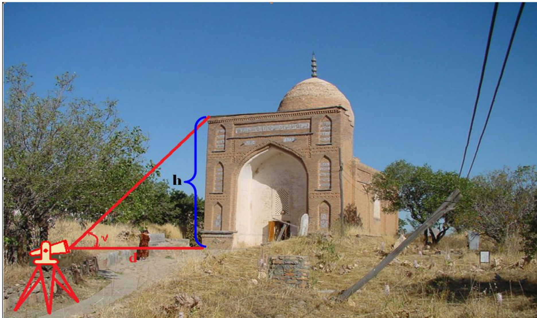
-расм. Тригонометрик нивелирлаш усулида « Қарши шаҳридаги одина жоме масжидини бапаллигини аниқлаш
