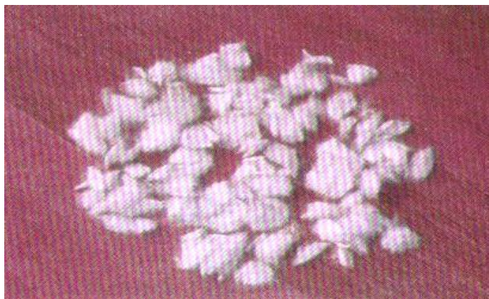
15.11 - расм. Флокли акрилат толали бўёқ қоплама
