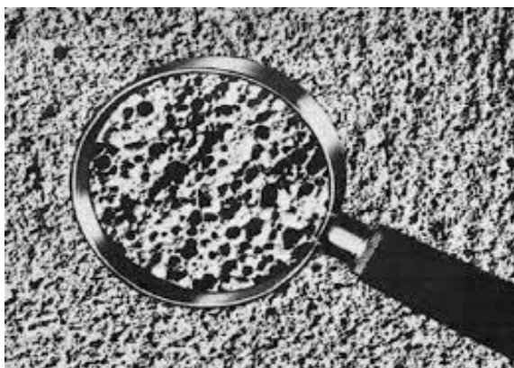
8.7 - расм. Ғоваклаштирилган енгил бетон тузлишининг микроскопда кўриниши
