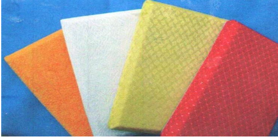
14.11 – расм. Толали акустик плиталар.
