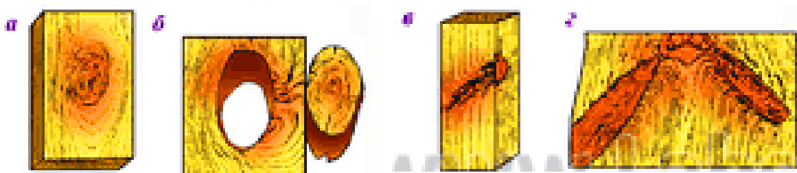
2.6 – расм. Ёғочдаги кўзларнинг жойланиши. а-битиб кетган соғлом; б-етилмай қуриб қолган кўзлар; в-тўқима битилган кўзлар; г-тарқалган кўзлар
