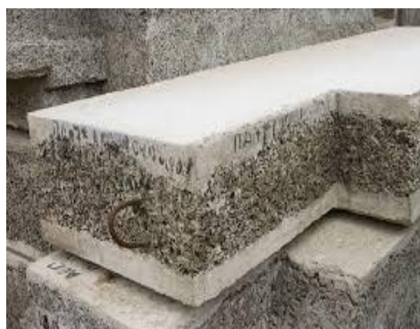
Керамзитбетонли девор панели
