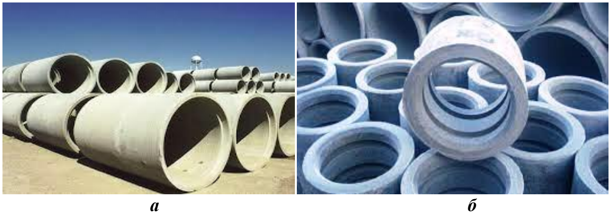
11.14 - расм. Асбестоцемент қувурлар (а) ва уларни туташтирувчи муфталар (б)
