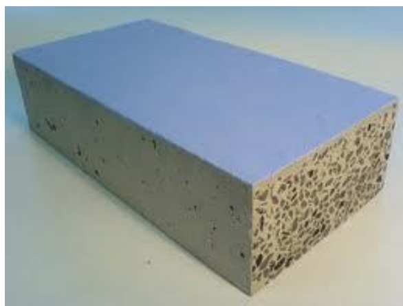
Ғоваклаштирилган бетон блок
