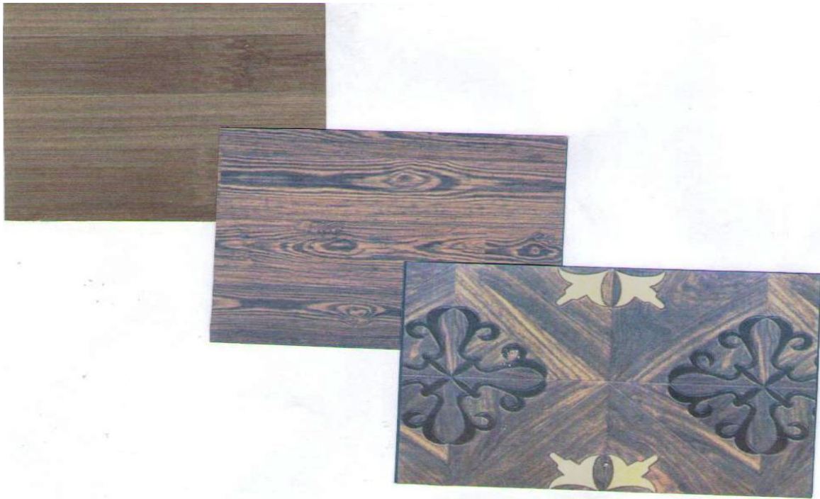
13.6 - расм. Ёғоч-полимерли плиталар
