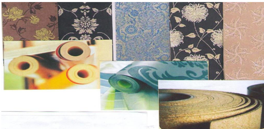
13.9 - расм. Қоғоз қатламли пардозбон полимер ўрама материаллар
