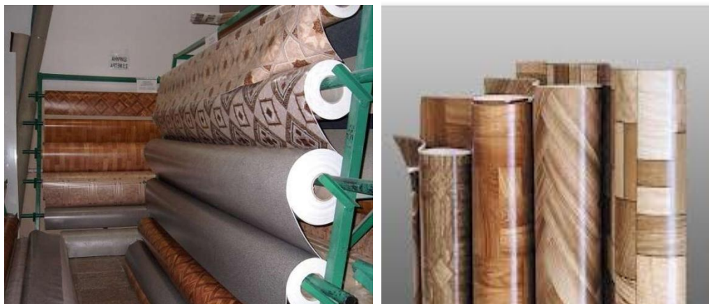
13.10 – расм. Линолеумли полбоп ўрама материаллар
