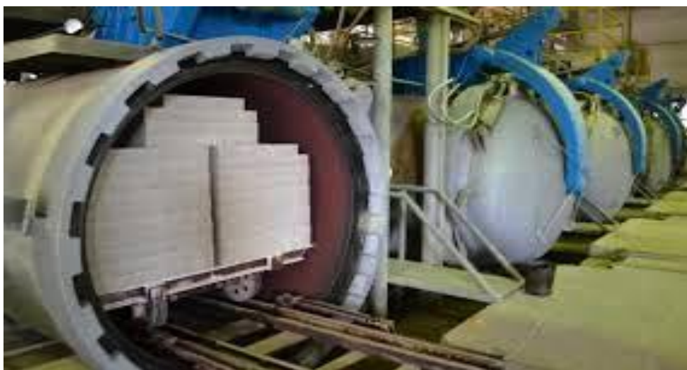
11.1 – расм. Автоклавга силикатли буюмларни жойлаш
