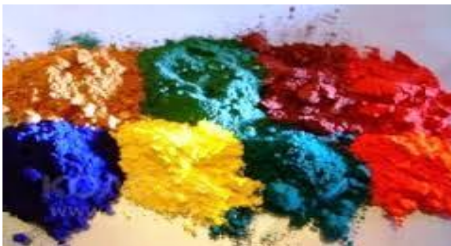
12.3 - расм. Рангли асфалтбетонлар учун ишлатиладиган пигментлар
