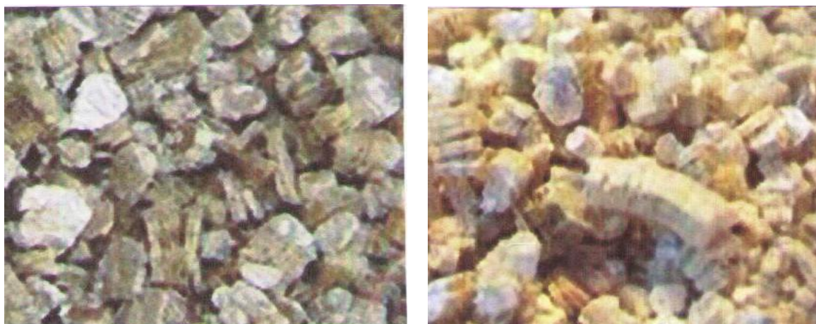
а б 14.3 – расм. Иссиқ сақловчи буюмлар олиш учун қўлланиладиган шиширилган перлит (а) ва вермикулит (б)
