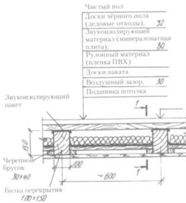
Рис.12.8. Устройство полов по балочному деревянному перекрытию
