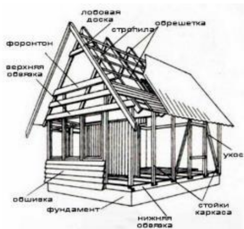
Рис.6.3.Конструктивные элементы деревянного каркасного жилого дома
