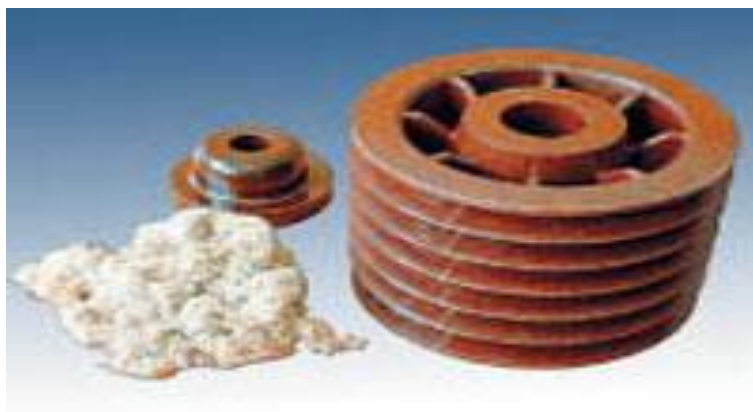
46-rasm. fenoplastlar va undan tayyorlangan detallar
