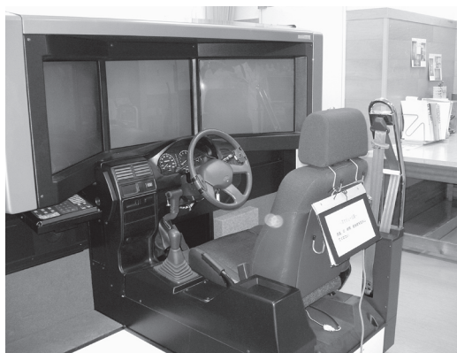
15-rasm. Avtomobilni qo‘lda boshqarishni mashq qiladigan trenajor.
