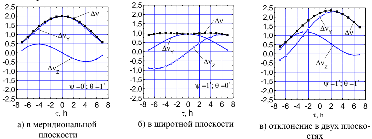
Рис. 10. Плоские углы отклонения луча b_H от расчетного положения во времени (в угл. мин.) для трех характерных случаев отклонения азимутальной оси от вертикали
