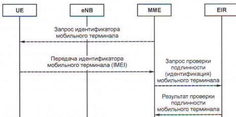
Рис. 2.4. Процедура проверки подлинности мобильного терминала
