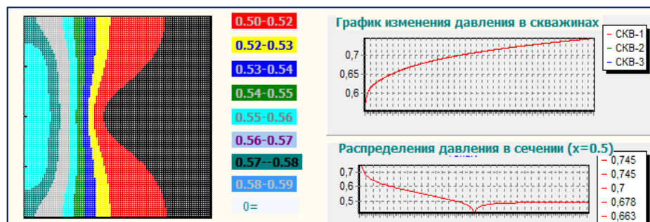
Рис. 5. Поддержка давления в пласте с блоковым заводнением
