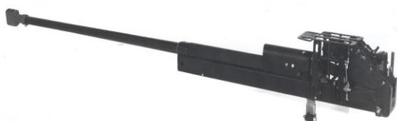
30 мм ли автоматик тўпи 2А42 душманнинг 2000 м гача узоқликда жойлашган енгил зирхли нишонларига қарши ва душманнинг 4000 м гача узоқликда жойлашган зирхсиз нишонларни ва жонли кучига қарши, шунингдек 2000 м гача баландлиқда ва 2500 м гача узоқликда 340 м/с овоз тезлигида учайдган ҳаводаги нишонларга қарши жанг қилиш учун мўлжалланган.
