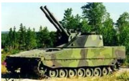
Самоходные минометы со стволом большого удлинения являются одним из последних достижений в области полевой артиллерии. Как и другие орудия этого класса, AMOS может вести огонь минами и снарядами различных калибров на расстояние до 10 километров.
