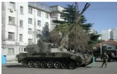
Шасси,установки "Пальмария" в основном аналогично шасси танка ОФ-40, однако силовой агрегат другой. Ствол длиной 39 калибров оснащен эжектором и двухщелевым дульным тормозом. В орудийной башне имеется собственная вспомогательная силовая установка для обеспечения энергией систем управления в том случае, если основной двигатель не работает. В автомате заряжания находятся 23 выстрела; еще семь выстрелов
