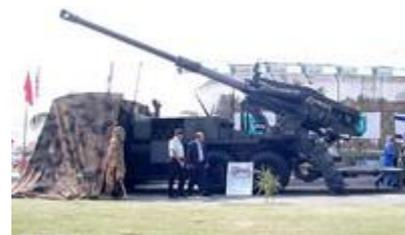
Soltam Systems разработала систему ATROM, которая уже установлена на шасси ROMAN 26.360 DFAEG 6x6. В системе используется ствол калибра 155 мм с длиной ствола 52 калибра, что позволяет вести стрельбу на расстоянии 41 км.
