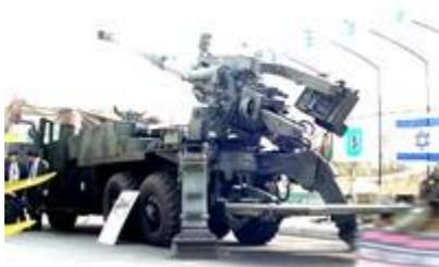
Системы ATMOS будут установлены в кормовой части шестиколесной платформы, производства American Truck Company. По договору, подписанному в конце 2004 года, IDF уже приняли поставку 300 грузовиков American Truck Company, сделанных на базе грузовика Tatra T815.
