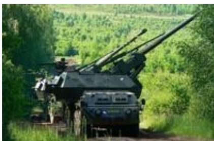
Семейство боеприпасов, используемых установкой ДАНА, похоже на современные типы 152-мм боеприпасов стран Восточного блока, хотя в основном все компоненты производились в бывшей Чехословакии. Стандартный фугасный снаряд имеет максимальную дальность выстрела 18700 метров - в настоящее время на стадии разработки находится по крайней мере один тип кассетных боеприпасов. Возимый боекомплект установки ДАНА составляет около 60 выстрелов.
