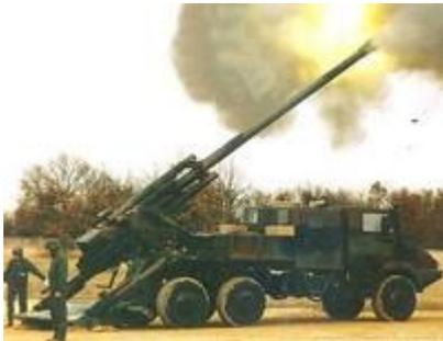
САУ устанавливаются на колесную формулу 6x6 грузового автомобиля Sherpa 5 от Renault. Кабина системы защищена броневыми листами, которые обеспечивают защиту экипажа от осколков и стрелкового оружия. В состав комплекса входит вся необходимая аппаратура для самостоятельного действия и быстрого развертывания на театре боевых действий.
