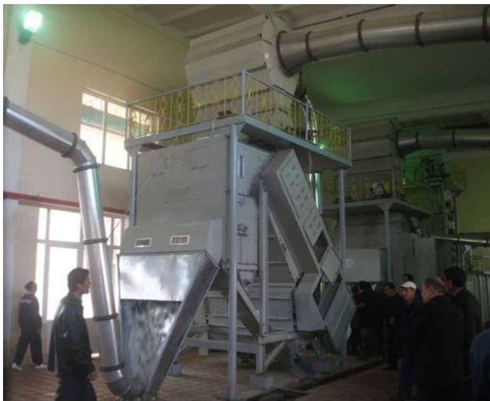
1.6-rasm. Toshkent viloyati “O‘zbekiston” pahta tozalash korhonasi pnevmotransport uskunasasi
