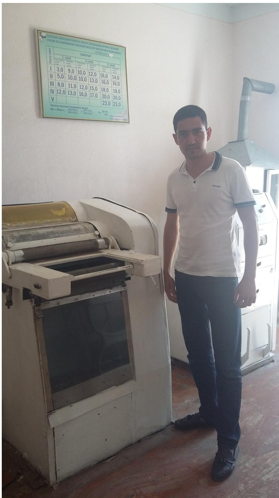
Поп пахта тозалаш заводи лабораториясидаги ЛКМ-маркали чигитли пахта ифлослигини аниқловчи прибор.
