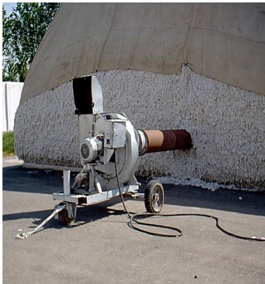
1-расм. Вентиляторни ғарамга ўрнатиш усули.
