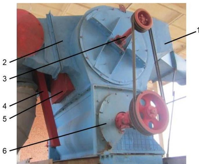
**Рис. 10. Устройство сепаратора, очищающего хлопок-сырец от мелких сорных и тяжелых примесей.**
