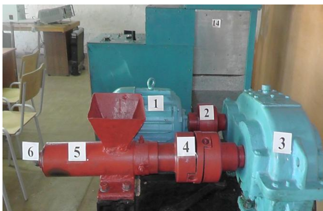
4.3-расм. Техник чигитдан пресслаш усули билан мойи олиш лаборатория қурилмаси:
