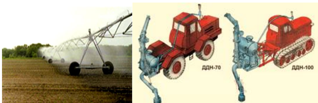
2.21-расм. Ёмғирлатиб суғориш агрегатлари: а-ДДА-100М; б-ДДН-70; в-ДДН-100.
