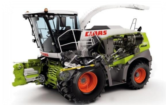
72-расм JAGUAR 494 ўзи юрар ем-хашак тайёрлаш машинаси
