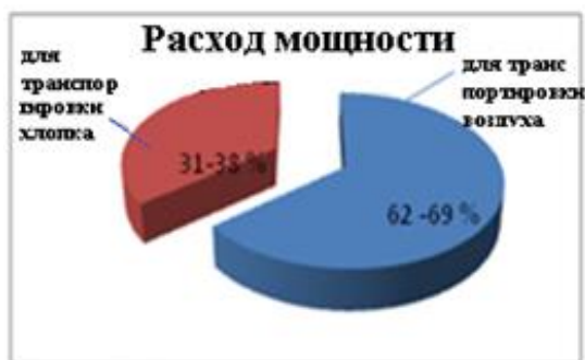
Рис. 6. Диаграмма относительного расхода мощности на перемещение компонентов аэросмеси
