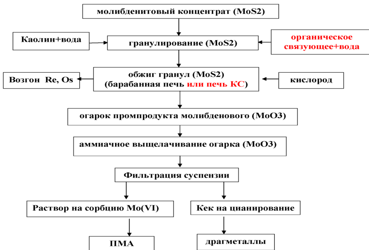
Рис. 7. Принципиальная технологическая схема процесса безкаолинового гранулирования и обжига Мо-концентрата в печи КС
